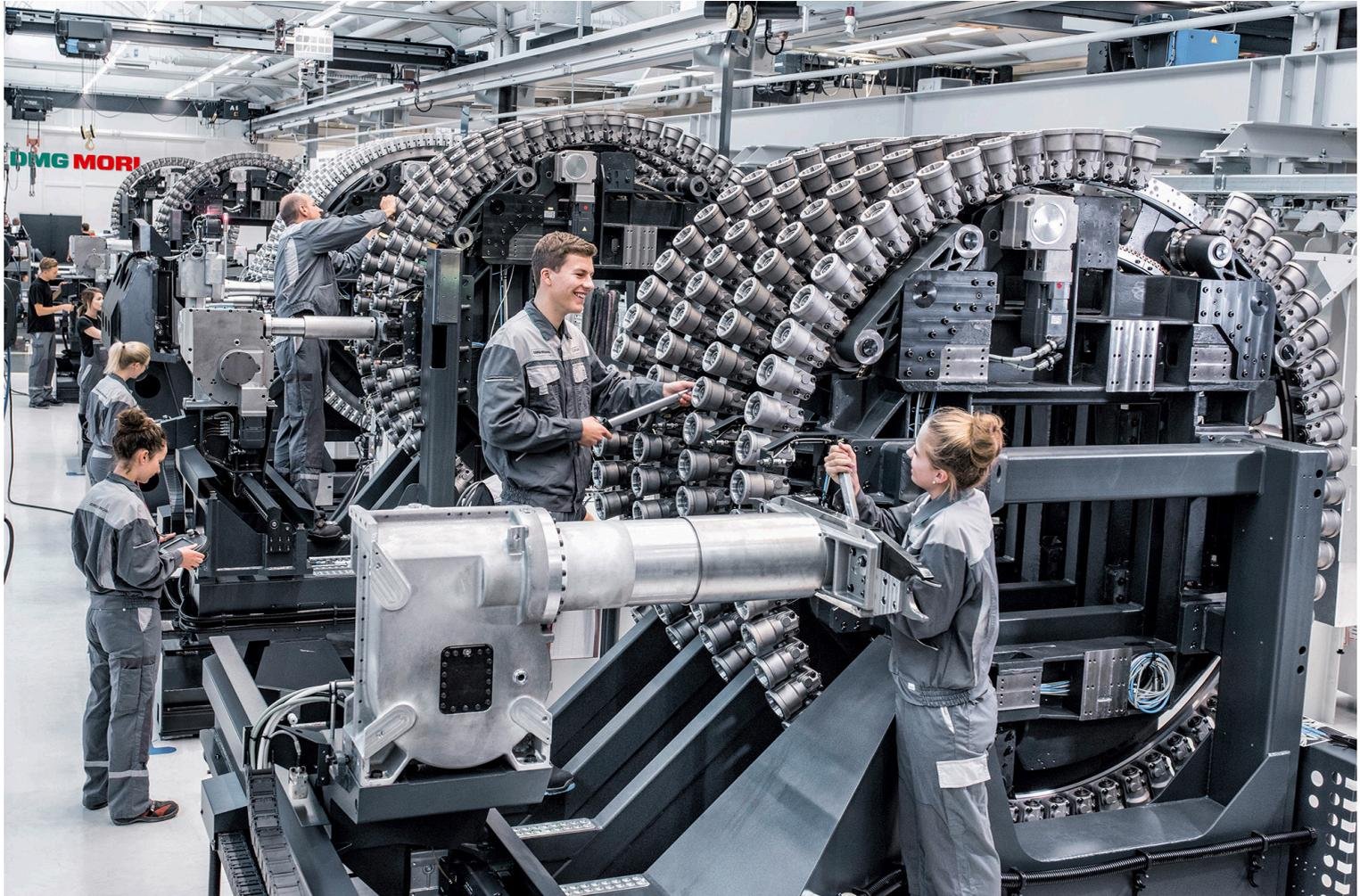
**Präzisionsarbeit bei DMG MORI:** Mitarbeiterinnen und Mitarbeiter bei DECKEL MAHO in Pfronten richten für die duoBLOCK-Baureihe das modular aufgebaute und patentierte Radmagazin mit Platz für mehr als 450 Werkzeuge aus.
