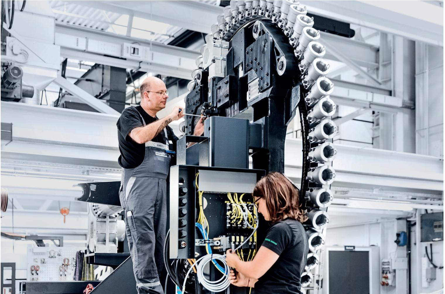
**Teamwork:** Gemeinsam montieren zwei Mitarbeiter der DECKEL MAHO Pfronten GmbH das hochmoderne Radmagazin einer Horizontal-Fräsmaschine.
