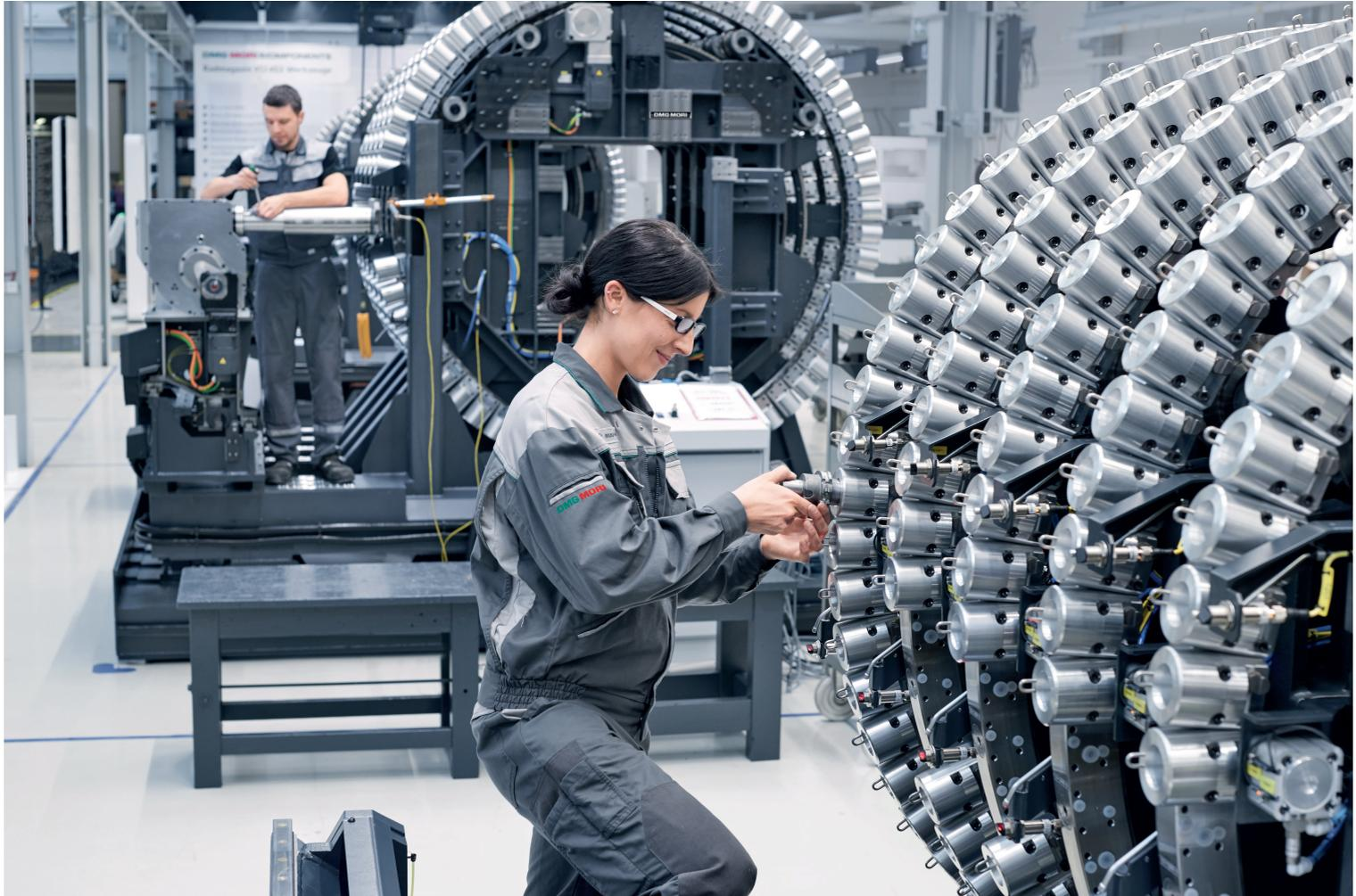
**Hightech von DMG MORI:** Mitarbeiter von DECKEL MAHO Pfronten justieren das Radmagazin einer DMC 80 H *linear* mit Platz für mehr als 400 Werkzeuge.
