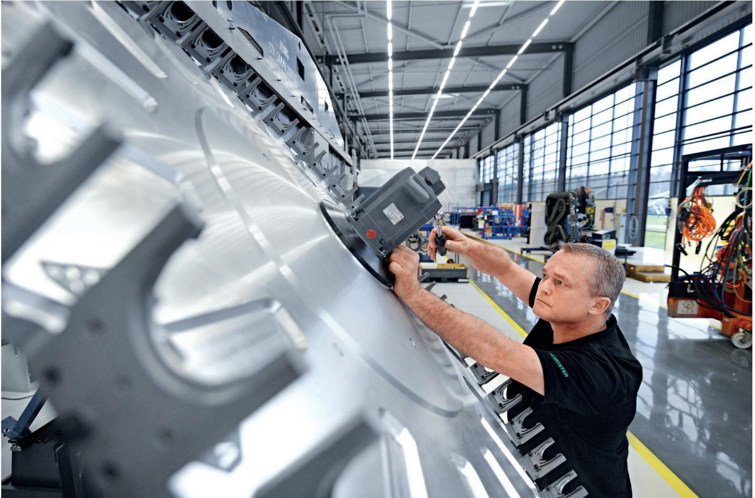
**Justierung eines Werkzeugmagazins:** Am Produktionsstandort in Bielefeld werden zukunftsweisende Drehmaschinen z. B. für den Werkzeug- und Formbau sowie für die Automobilbranche hergestellt.
