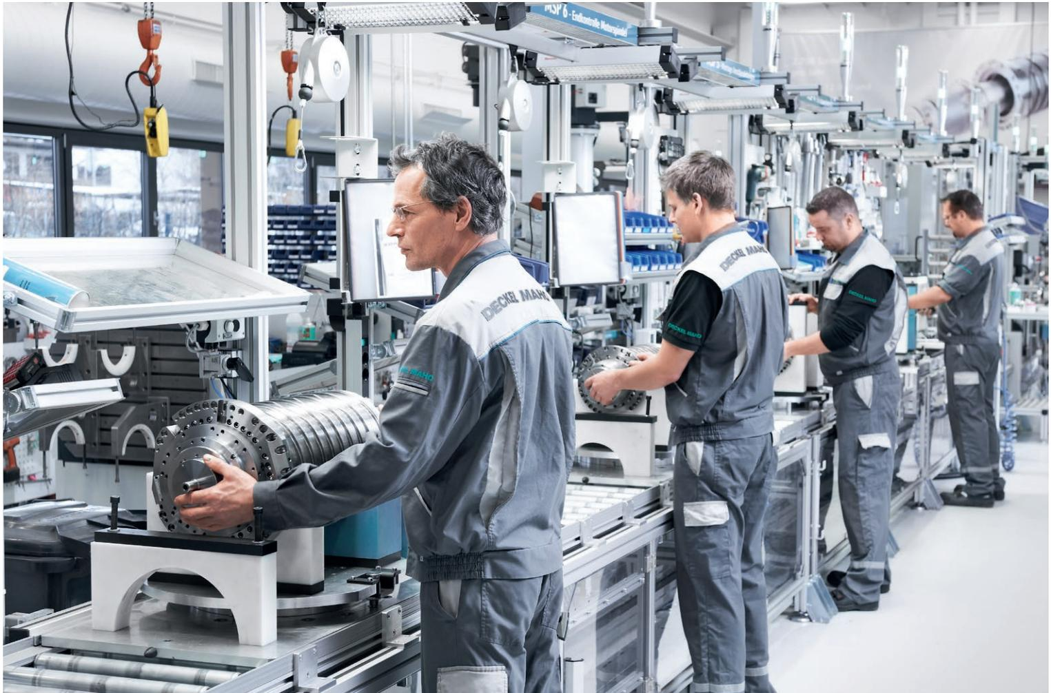
**Getaktete Fließmontage:** Mitarbeiter von DECKEL MAHO in Pfronten prüfen die Einstellungen einer Motorspindel – das Herzstück jeder Werkzeugmaschine.
