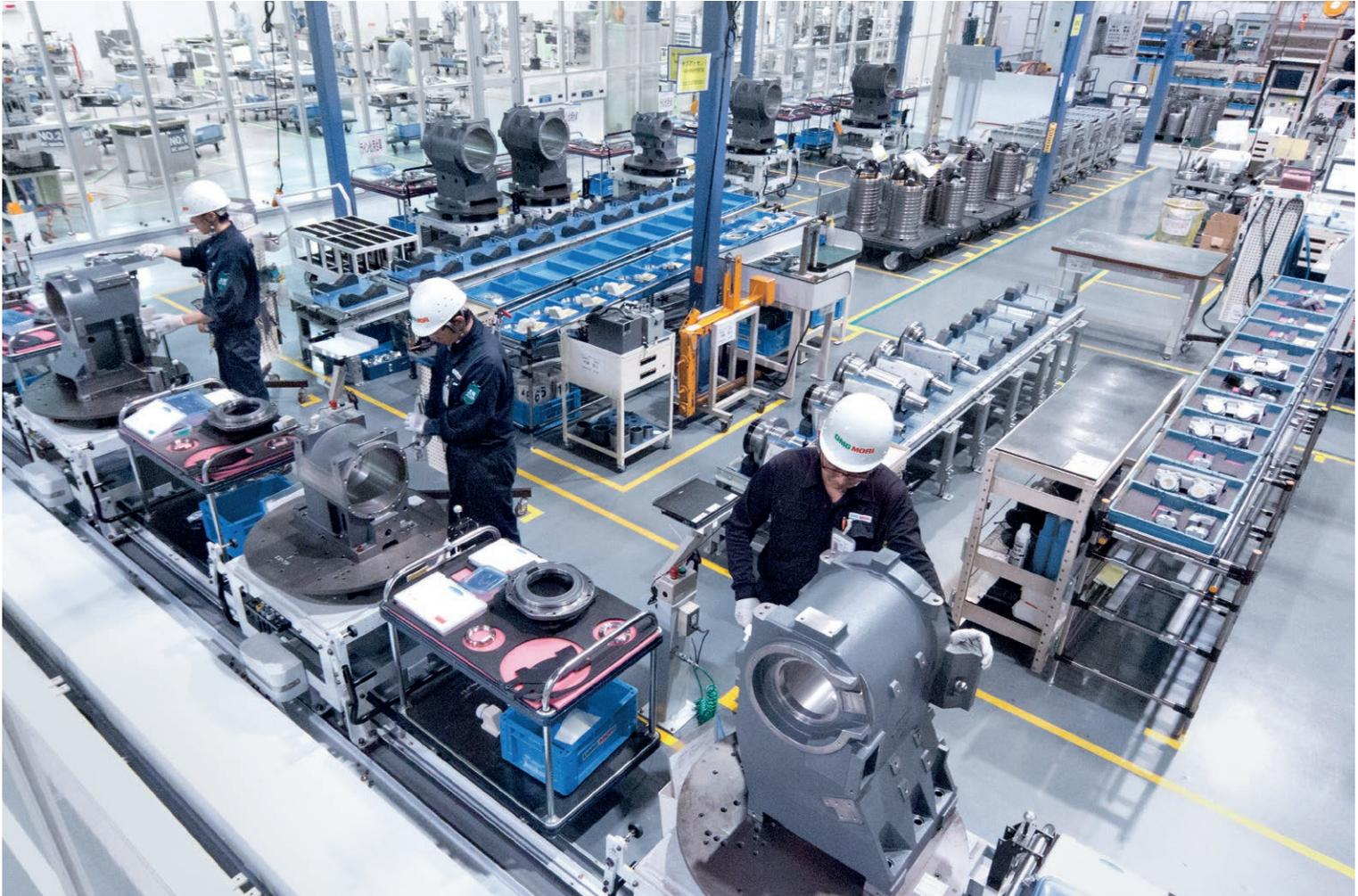
**Präzisionsmontage:** Im japanischen Werk der DMG MORI SEIKI COMPANY LIMITED in Iga werden Hauptspindeln für Drehmaschinen der NLX-Baureihe montiert, die insbesondere in der Automobilindustrie eingesetzt werden.
