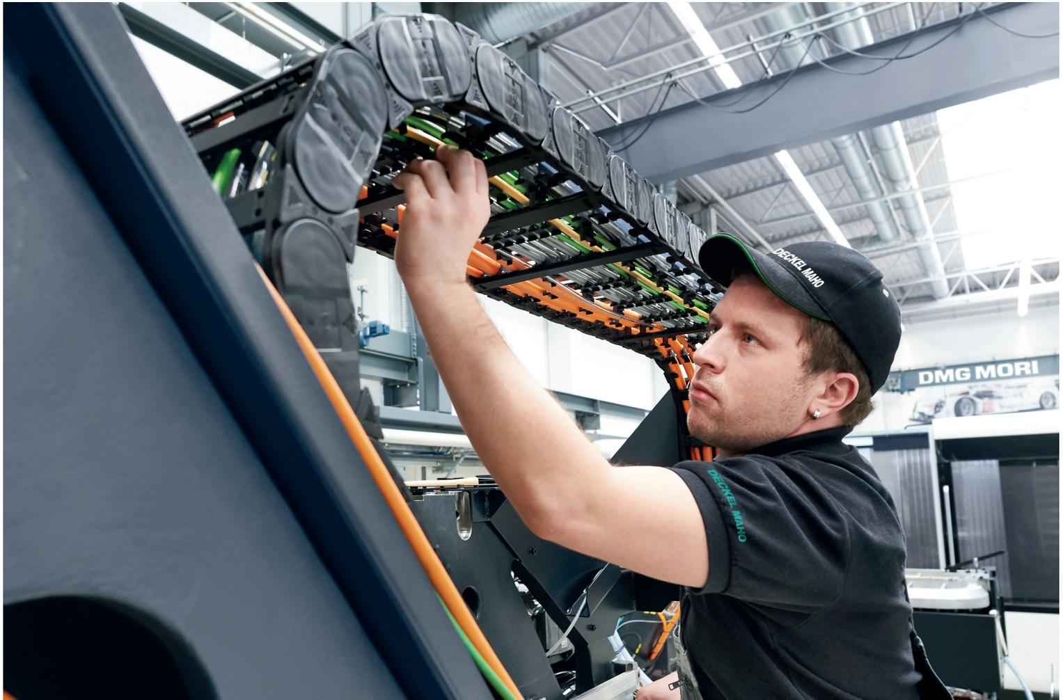
**Qualitätssicherung:** Ein Mitarbeiter von DECKEL MAHO in Seebach verschraubt die Energiezufuhr an der Universal-Fräsmaschine DMF 260 | 11, die unter anderem in der Luft- und Raumfahrt eingesetzt wird.
