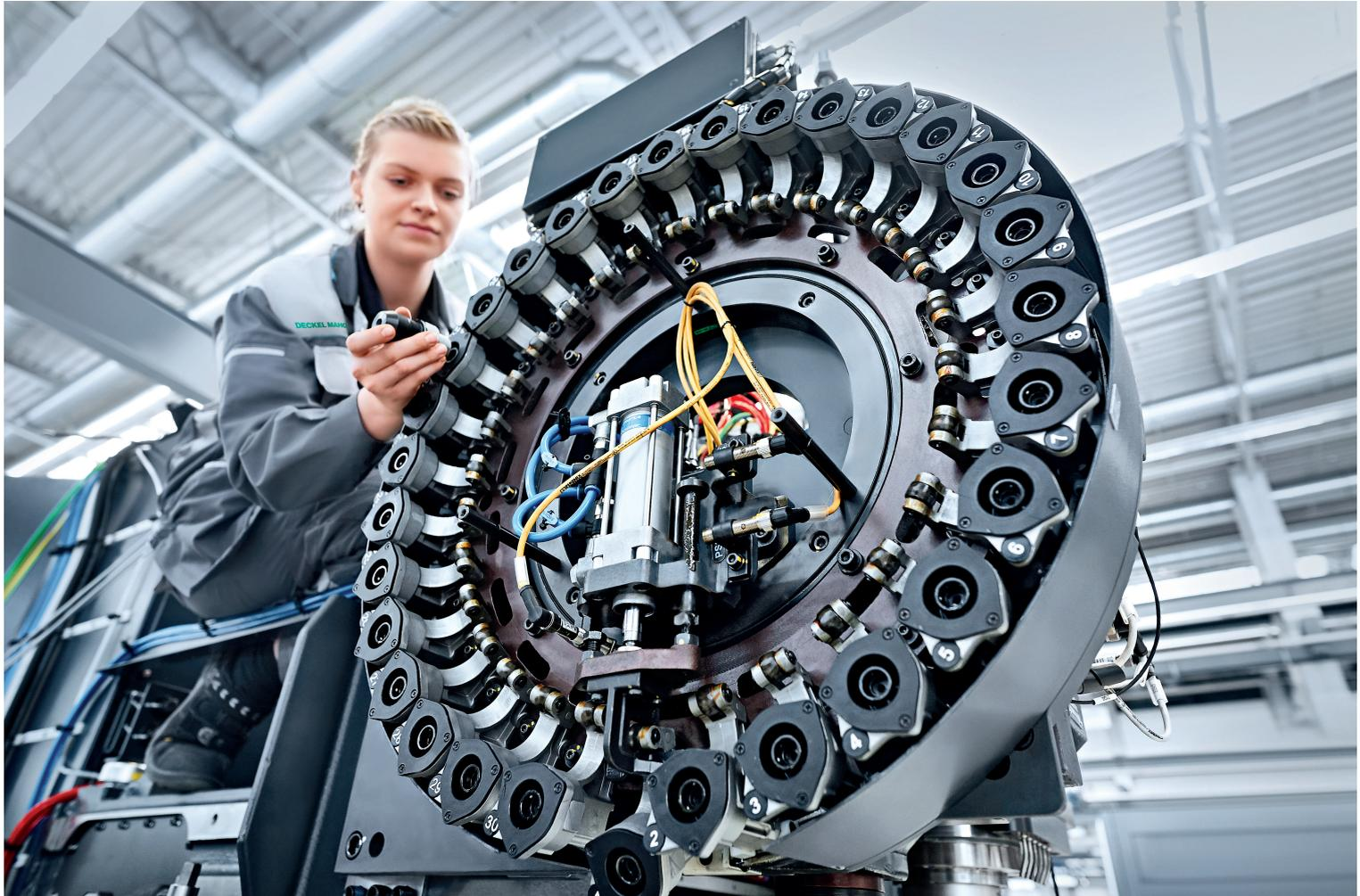
**Präzisionstechnik:** Eine Mitarbeiterin von DECKEL MAHO in Seebach richtet den Werkzeugwechsler einer HSC 30 *linear* aus. Dieses High-Speed-Cutting Präzisionszentrum findet insbesondere in der modernen Medizintechnik bei der Fertigung von Gelenk-Komponenten oder chirurgischen Instrumenten Anwendung.
