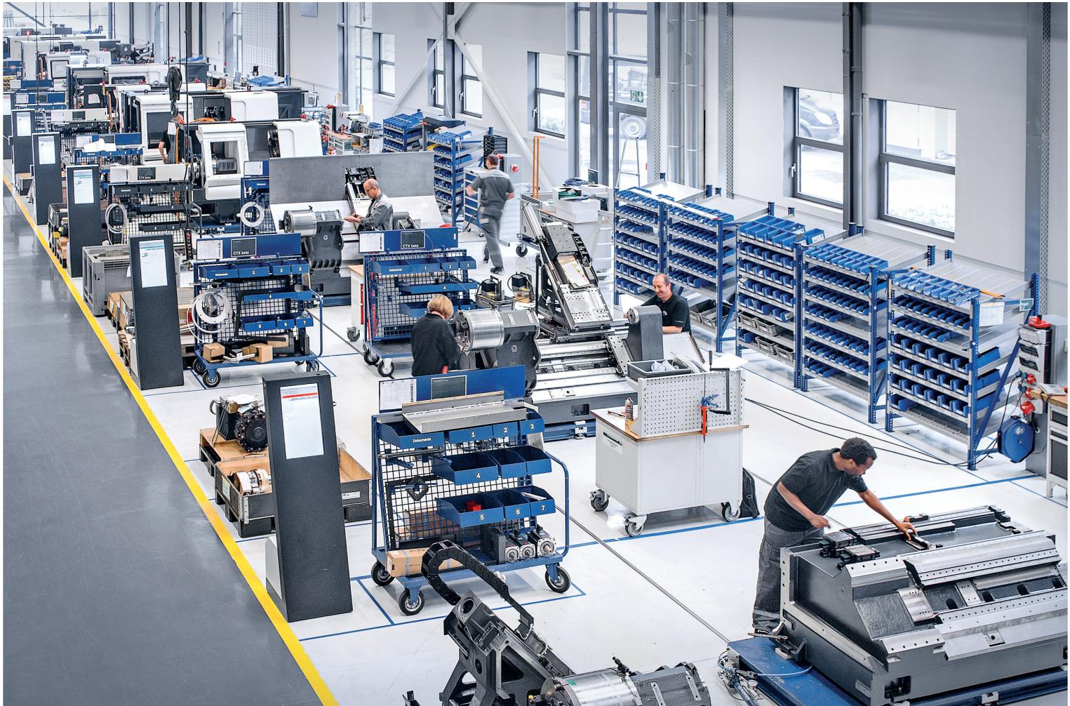
**Effiziente Fließmontage:** In 14 Takten fertigen Mitarbeiter der GILDEMEISTER Drehmaschinen GmbH in Bielefeld unter anderem die CTX beta 800 TC. Dieses hochpräzise Dreh-Fräszentrum gewann im Februar 2015 den Innovationspreis und wird insbesondere im Maschinen- und Anlagenbau eingesetzt.
