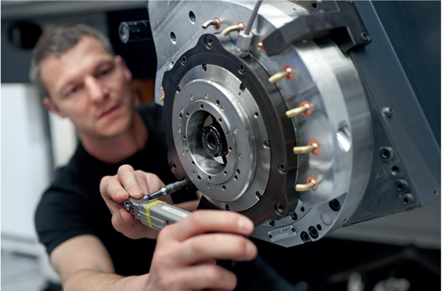
**Hightech-Maschinen von DMG MORI:** Montage eines Spindelstocks für Großmaschinen im Produktionswerk der DECKEL MAHO Pfronten GmbH.
