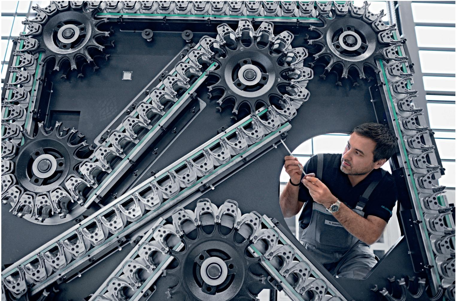
**Hightech-Maschinen von DMG MORI:** Montage und Justierung eines Kettenmagazins bei der GILDEMEISTER Drehmaschinen GmbH am Standort Bielefeld.
