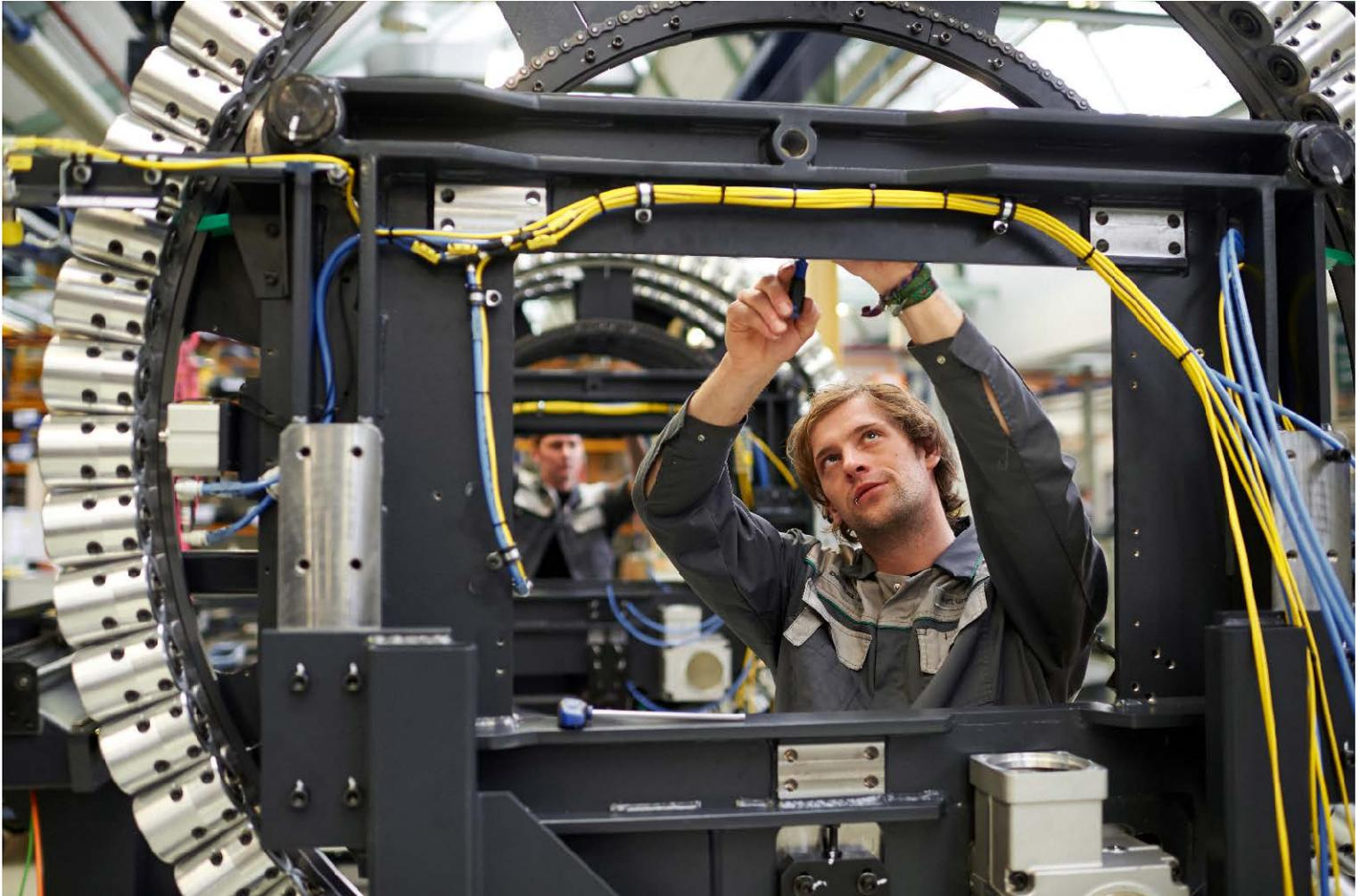
**Technologien und Innovationen von DMG MORI:** Im Produktionswerk von Großmaschinen in Pfronten montiert ein Industriemechaniker ein Werkzeugmagazin für die DMC 60 H *linear*.
