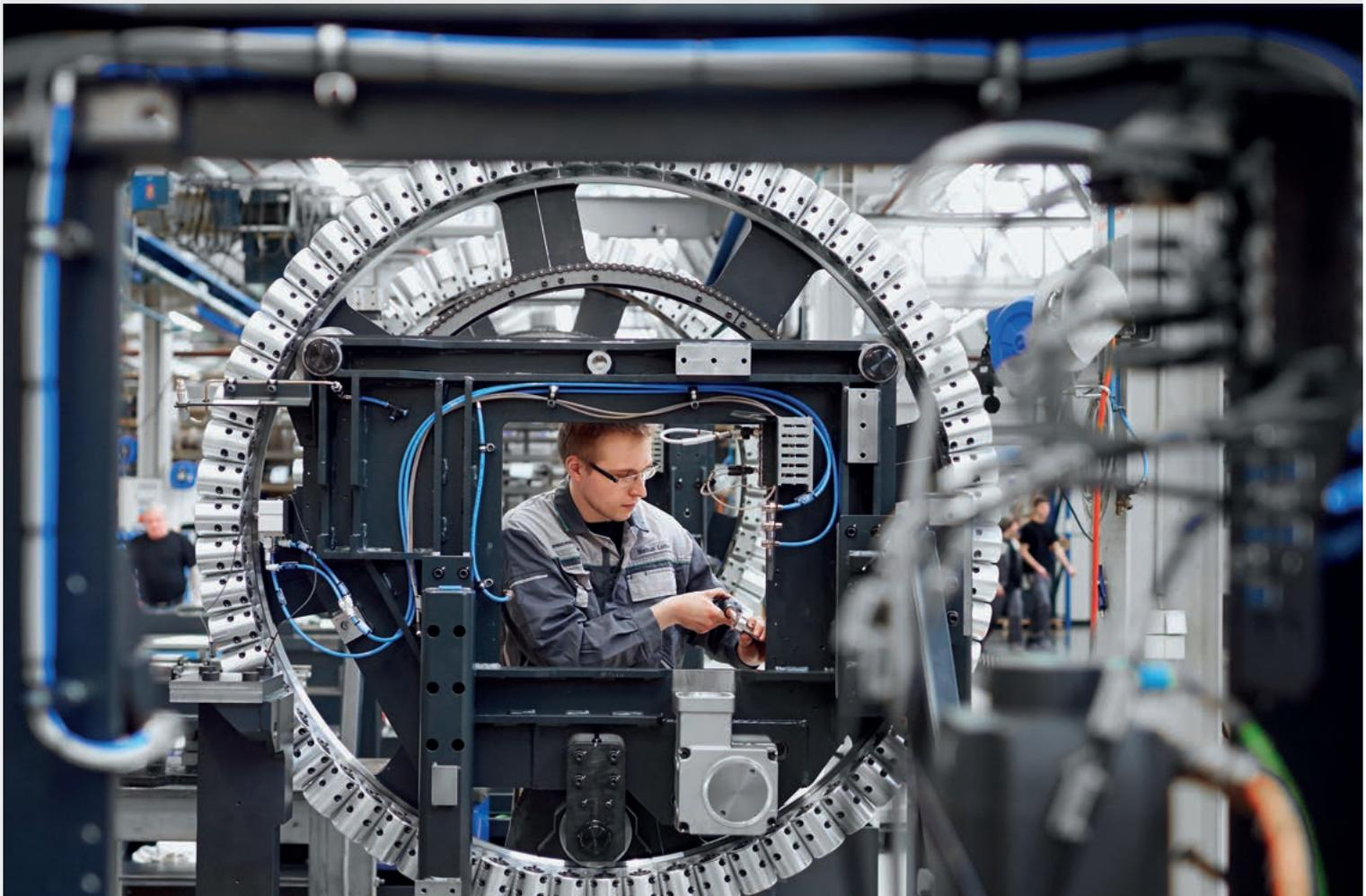
**Große Dimensionen:** Markus Lotter, Industriemechaniker bei der DECKEL MAHO Pfronten GmbH, montiert ein Werkzeugmagazin für eine DMC 60 H *linear*.
