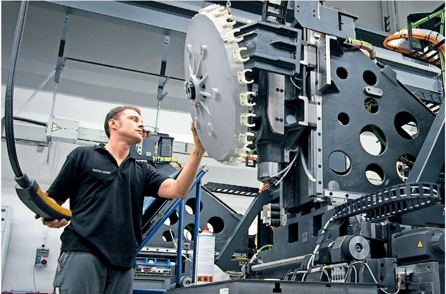
**Montage eines Werkzeugwechslers:** Dirk Ziegler, Montageschlosser bei der DECKEL MAHO Seebach GmbH, montiert den Werkzeugwechsler einer MILLTAP 700.
