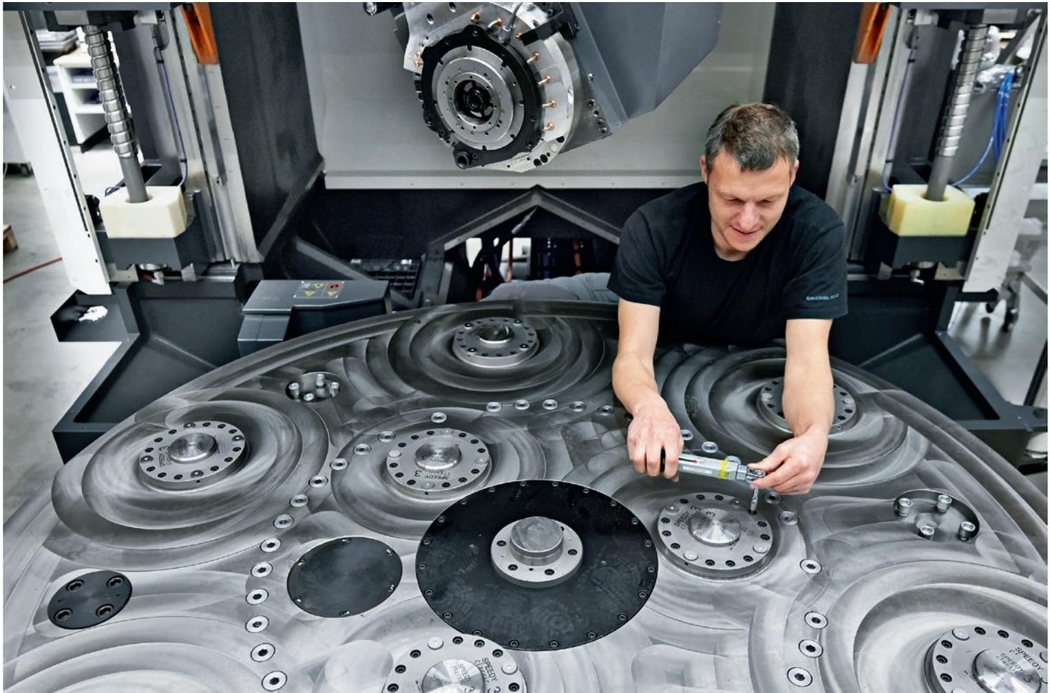
**Hightech-Maschinen von DMG MORI:** Im Produktionswerk von DECKEL MAHO in Pfronten justiert ein Mitarbeiter Buchsen an der 5-Achs-Portalmaschine DMC 210 FD.
