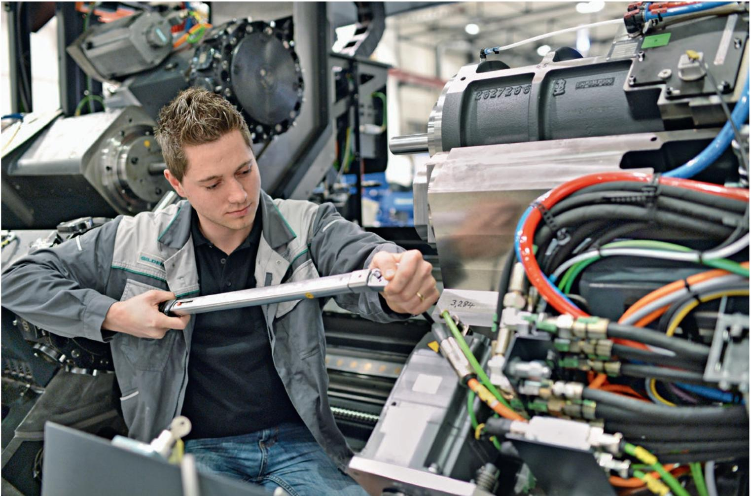
**Präzisionsarbeit:** Im Produktionswerk der GILDEMEISTER Drehmaschinen GmbH in Bielefeld montiert ein Mitarbeiter die Verdichtungsschläuche an der CTX gamma 2000 TC *linear*.
