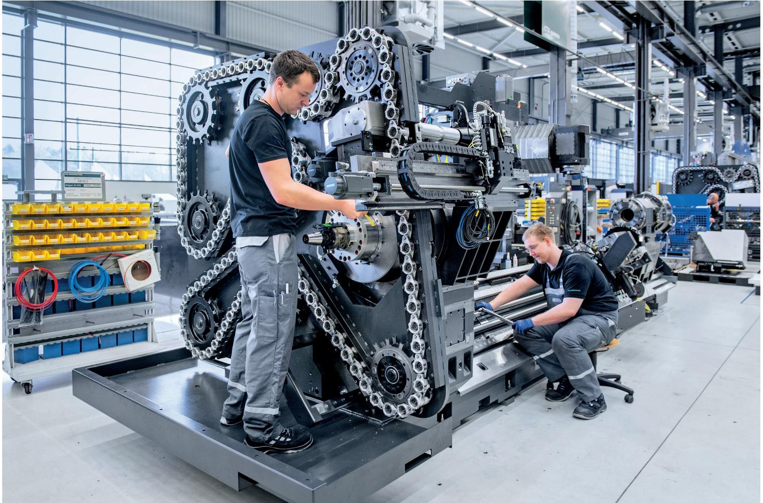
**Komplettbearbeitung auf einer Maschine:** Zwei Mitarbeiter der GILDEMEISTER Drehmaschinen GmbH in Bielefeld montieren das Kettenmagazin einer Universal-Drehmaschine ein.
