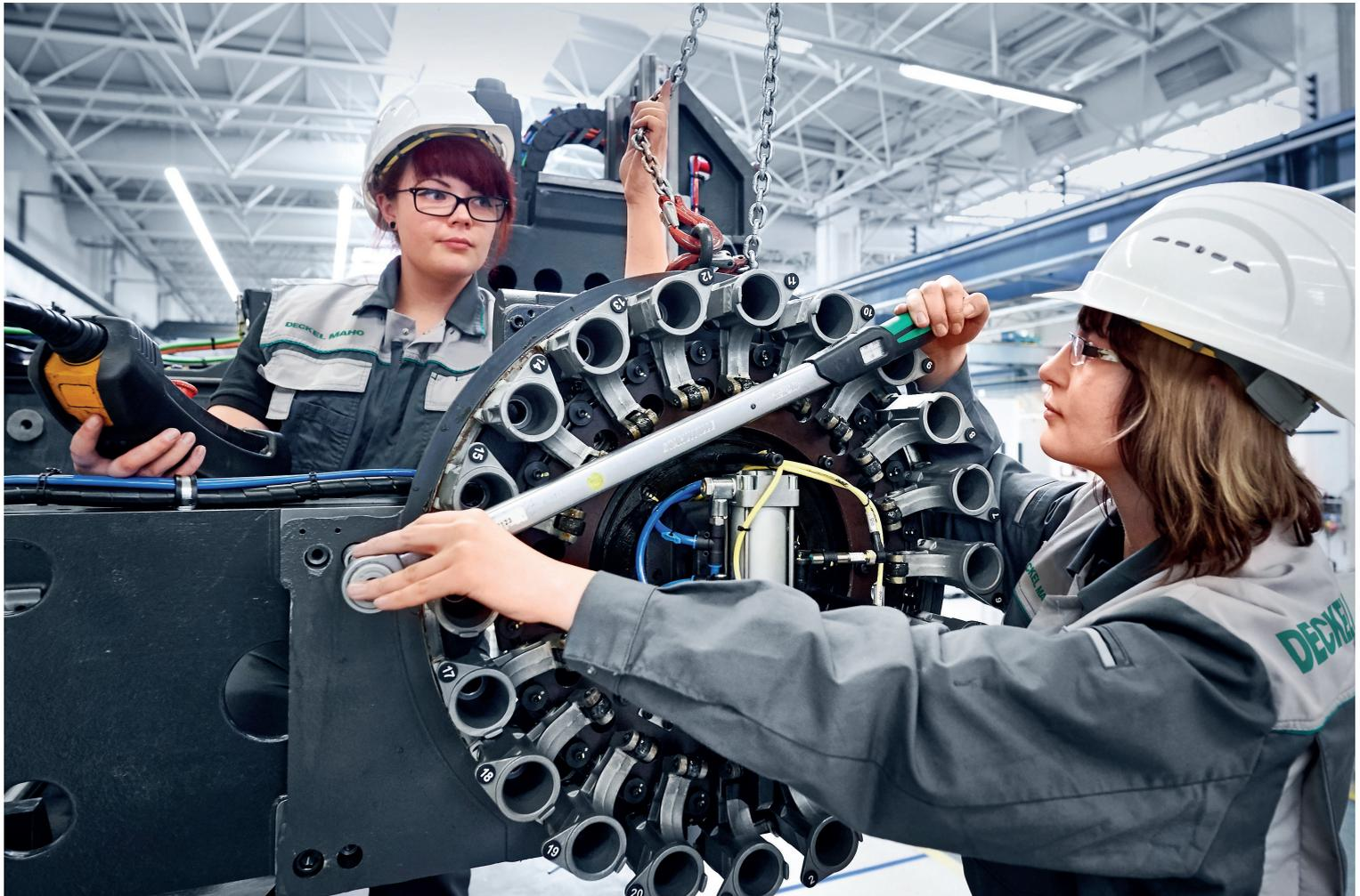
**Teamwork:** Zwei Auszubildende bei DECKEL MAHO Seebach montieren gemeinsam den Werkzeugwechsler einer DMC 1150 V. Dieses Vertikal-Bearbeitungszentrum wird unter anderem auch im Werkzeug- und Formenbau eingesetzt.
