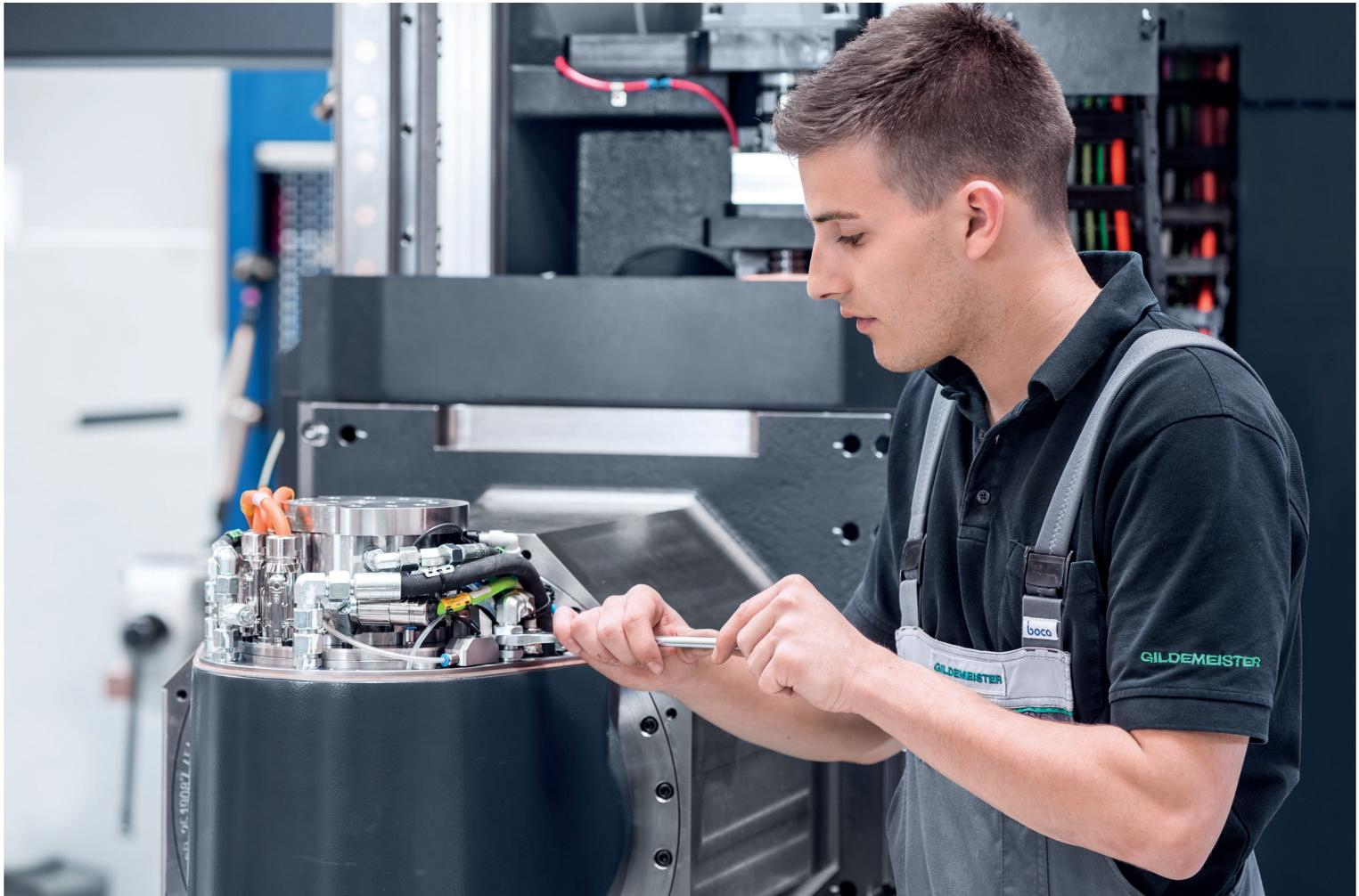
**Präzisionsarbeit:** Ein Mitarbeiter der GILDEMEISTER Drehmaschinen GmbH in Bielefeld montiert Hydraulikschläuche an der Spindel eines Werkzeugschlittens. Dieser wird beispielsweise in die Universal-Drehmaschine CTX gamma 2000 eingebaut, auf der Hydraulikkomponenten für die Automobilindustrie gefertigt werden.
