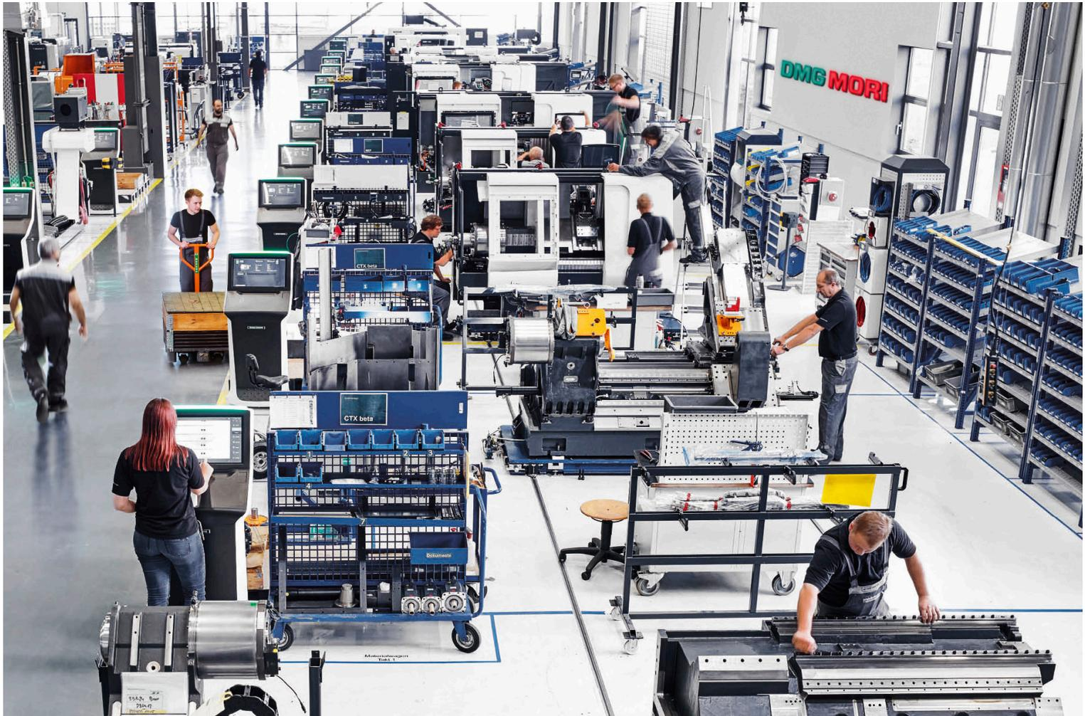
**Effiziente Fließmontage:** In 14 Takten fertigen Mitarbeiter der GILDEMEISTER Drehmaschinen GmbH in Bielefeld unter anderem die Universal-Drehmaschine NEF 400. Standardisierte Abläufe gewährleisten hohe Effizienz und Prozesssicherheit.
