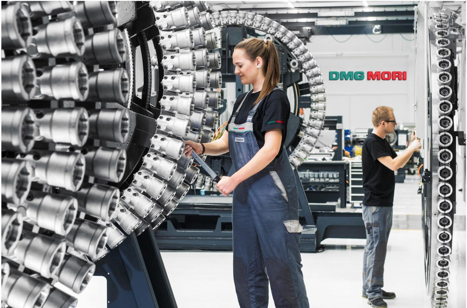
**Präzisionsarbeit bei DMG MORI:** Franziska Dreier, Industriemechanikerin bei DECKEL MAHO in Pfronten, richtet für die duoBLOCK-Baureihe das modular aufgebaute und patentierte Radmagazin mit Platz für mehr als 450 Werkzeuge aus.
