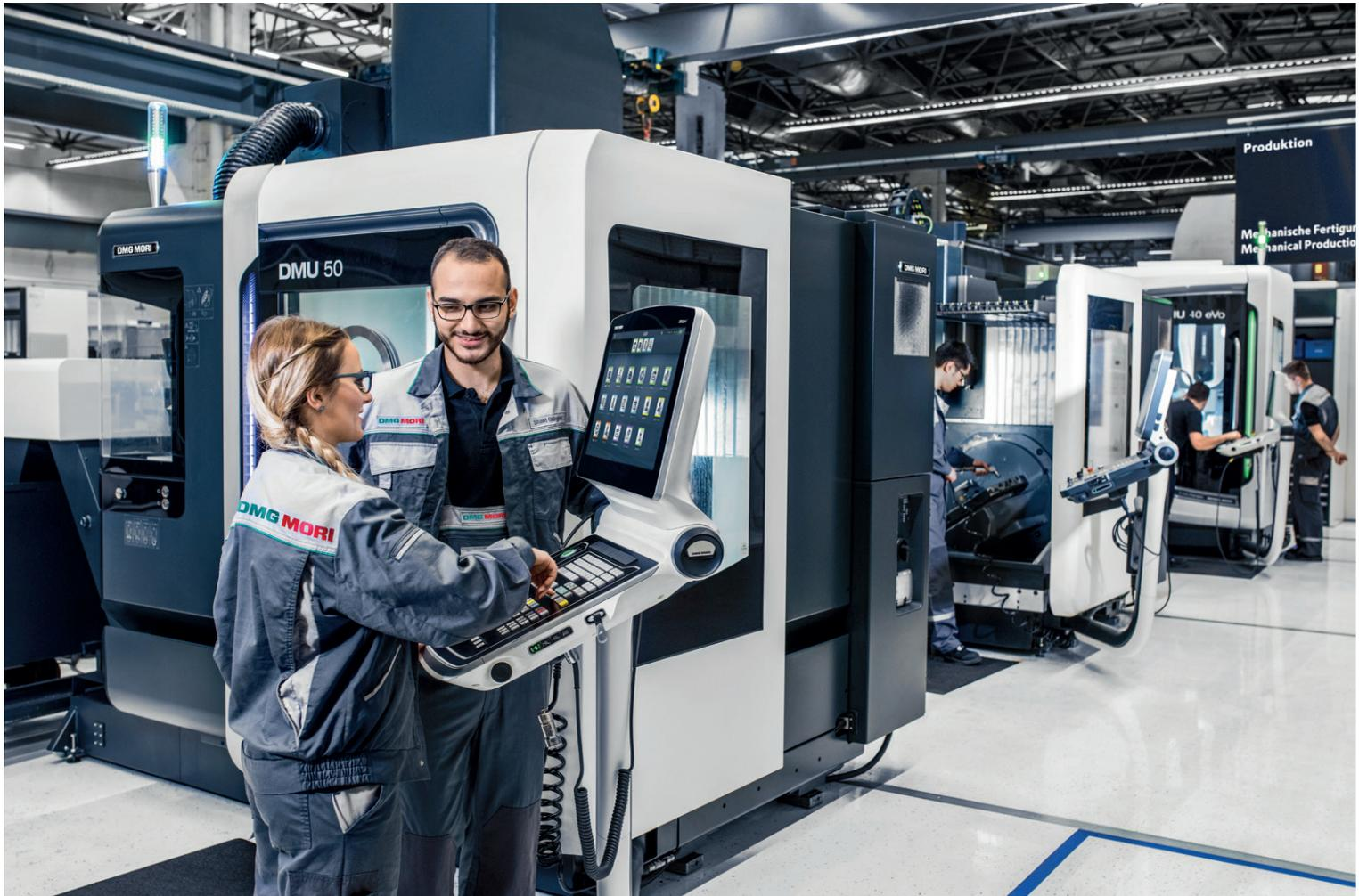
**Attraktiver Arbeitgeber:** Bei DECKEL MAHO in Seebach werden die Auszubildenden früh für Industrie 4.0 fit gemacht. Laura Hermann und Dimitri Guloglou programmieren die DMU 50, eine Universal-Fräsmaschine für die 5-Achs-Bearbeitung, über die innovative APP-basierte Steuerungs- und Bediensoftware CELOS.
