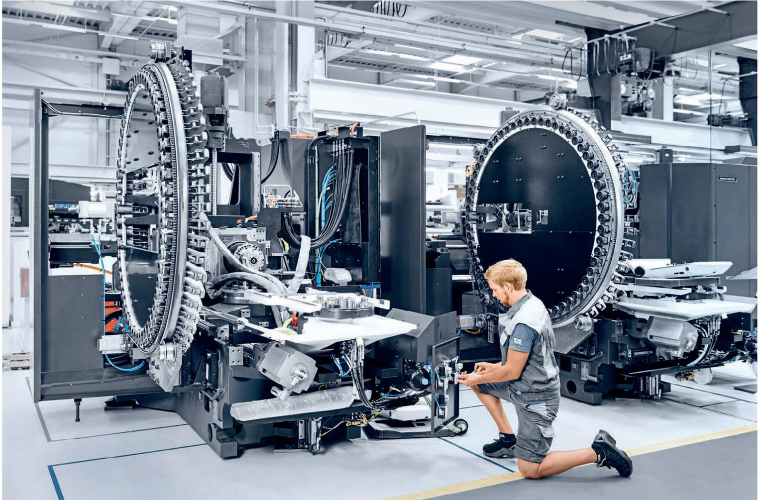
**Dynamisch und präzise:** Ein Mitarbeiter von DMG MORI stellt die Spannhydraulik des Horizontal-Bearbeitungszentrums NHX 4000 ein. Die Hightech-Maschine wird bei DECKEL MAHO in Pfronten produziert und u.a. in der Automobilindustrie eingesetzt.
