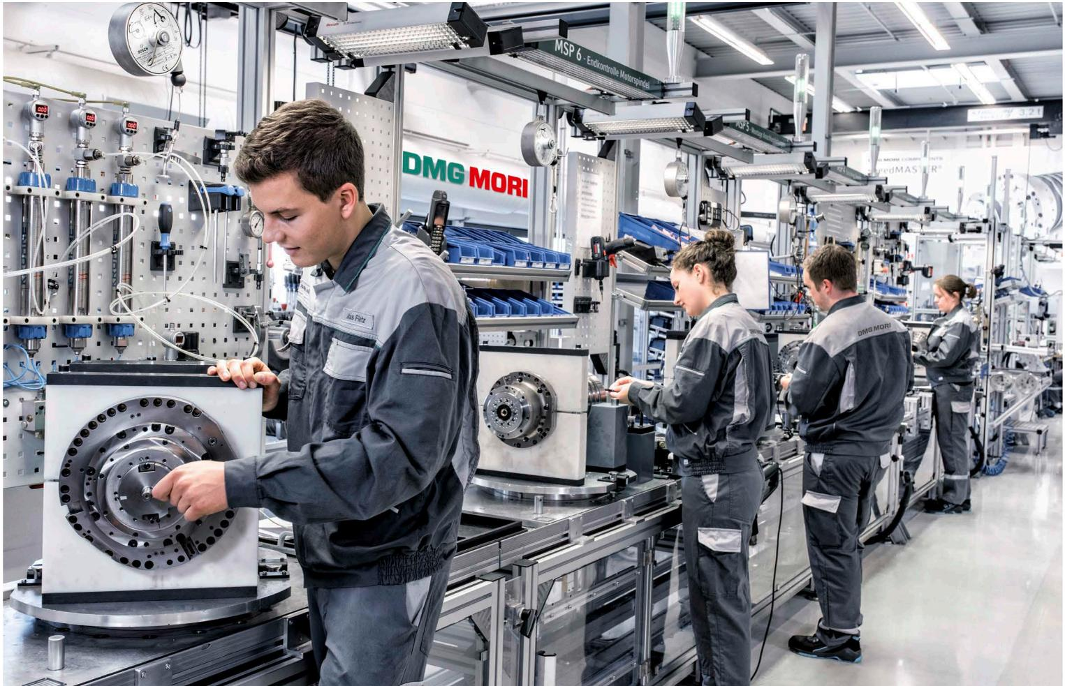
**Getaktete Spindelmontage:** An modernen Hightech-Arbeitsplätzen fertigen Mitarbeiterinnen und Mitarbeiter von DMG MORI pro Jahr mehr als 4.000 speedMASTER-Spindeln. Als Herzstück jeder Werkzeugmaschine haben Motorspindeln einen enormen Einfluss auf die Präzision und Oberflächenqualität der Werkstücke. Ihre Standfestigkeit und Dauergenauigkeit wirkt sich unmittelbar auf die Zuverlässigkeit und die Nutzungsquote von Werkzeugmaschinen aus.
