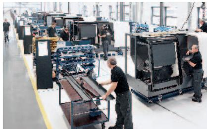
Die neue Fließmontage bei der GILDEMEISTER Drehmaschinen GmbH wird im Betrieb genommen. Hier können nun CTX- und NEF-Maschinen im Taktbetrieb montiert werden. Große Montageмонitore an jedem Takt zeigen den Fortschritt.
