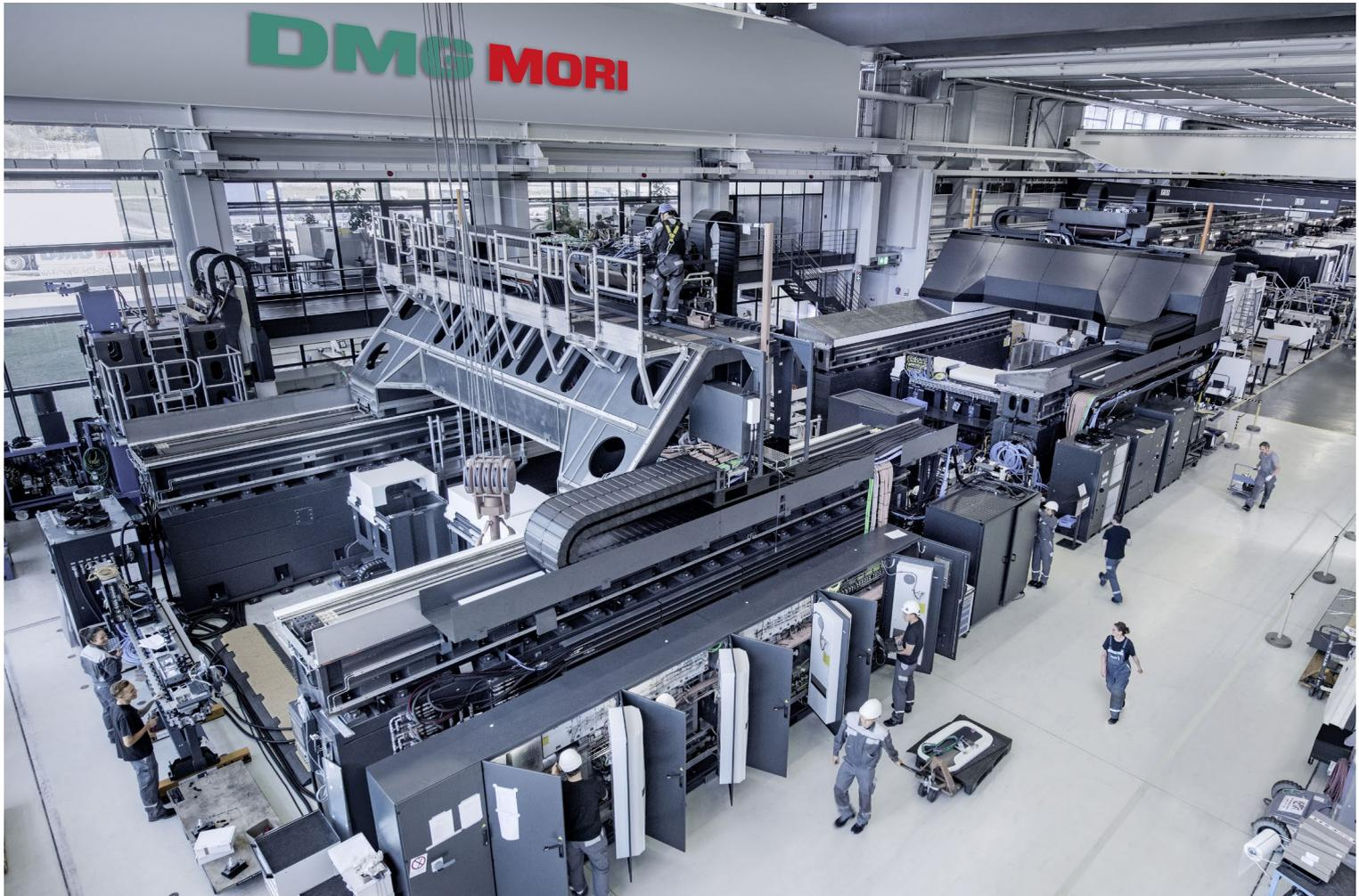
**Maschinen für die Großteilmbearbeitung:** In der Montagehalle für XXL-Maschinen produziert DMG MORI unter anderem die DMU 600 Gantry. Das 5-Achs-Universal-Bearbeitungszentrum ist so groß wie ein zweigeschossiges Einfamilienhaus.
