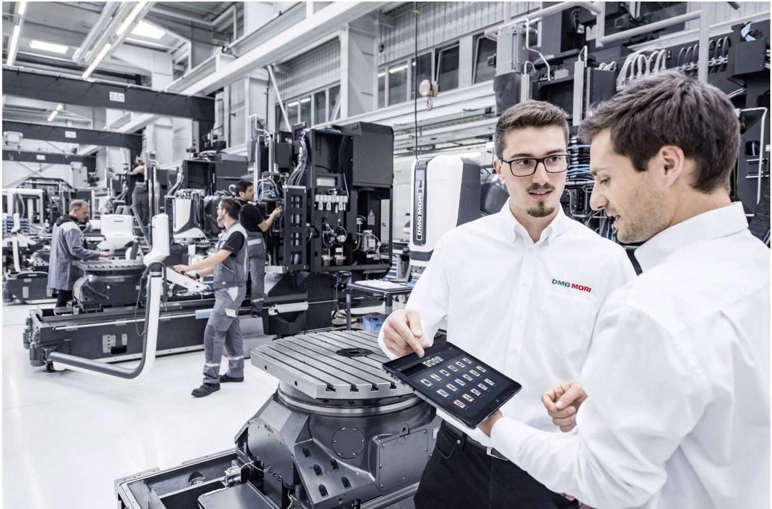
**Durchgängige und transparente Digitalisierung:** Mit dem CELOS PROtab bietet DMG MORI einen mobilen Assistenten für die vernetzte Fertigung. DMG MORI Kunden können so CELOS-Funktionen im gesamten Shopfloor-Bereich nutzen – auch auf Bestandsmaschinen und Fremdfabrikaten.
