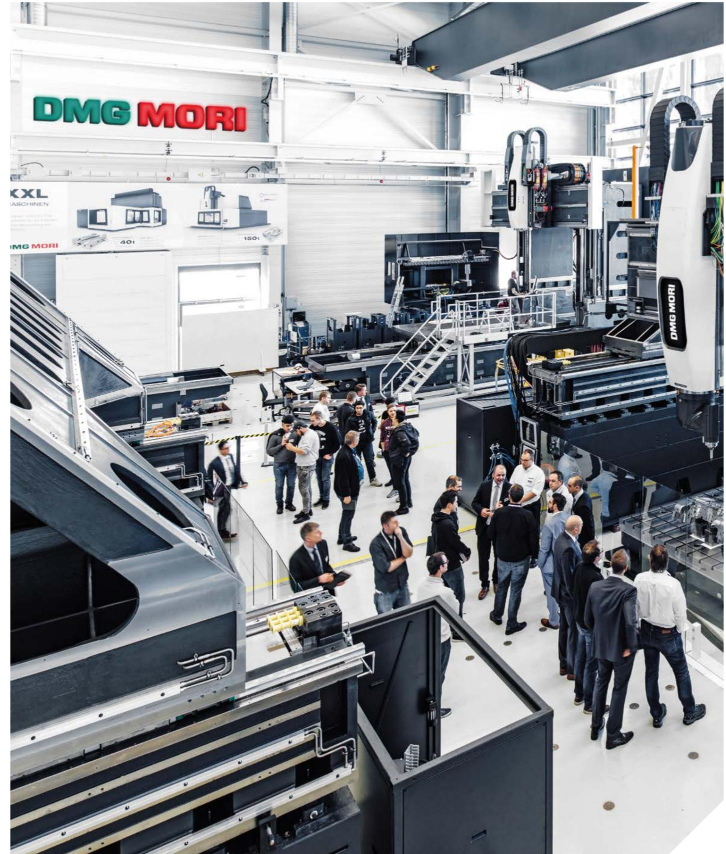
**Energieeffiziente Montagehalle für XXL-Maschinen:** Bei DECKEL MAHO in Pfronten werden alle Produktionshallen durch Kälteentnahme aus 19 Grundwasserbrunnen gekühlt. Hochmoderne Wärmetauscher sorgen für eine stabile Raumtemperatur von 22°C.
