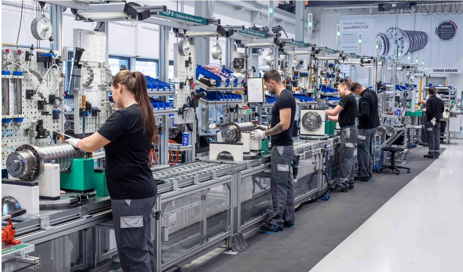
**Getaktete Spindelmontage:** An modernen Hightech-Arbeitsplätzen fertigen Mitarbeiterinnen und Mitarbeiter von DMG MORI pro Jahr mehr als 4.000 speedMASTER-Spindeln. Als Herzstück jeder Werkzeugmaschine haben Motorspindeln einen enormen Einfluss auf die Präzision und Oberflächenqualität der Werkstücke.
